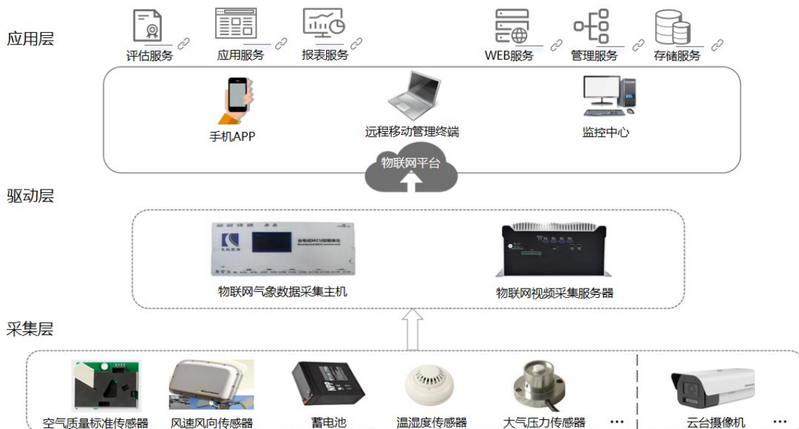
图1 公路沙害监测预警技术架构图
